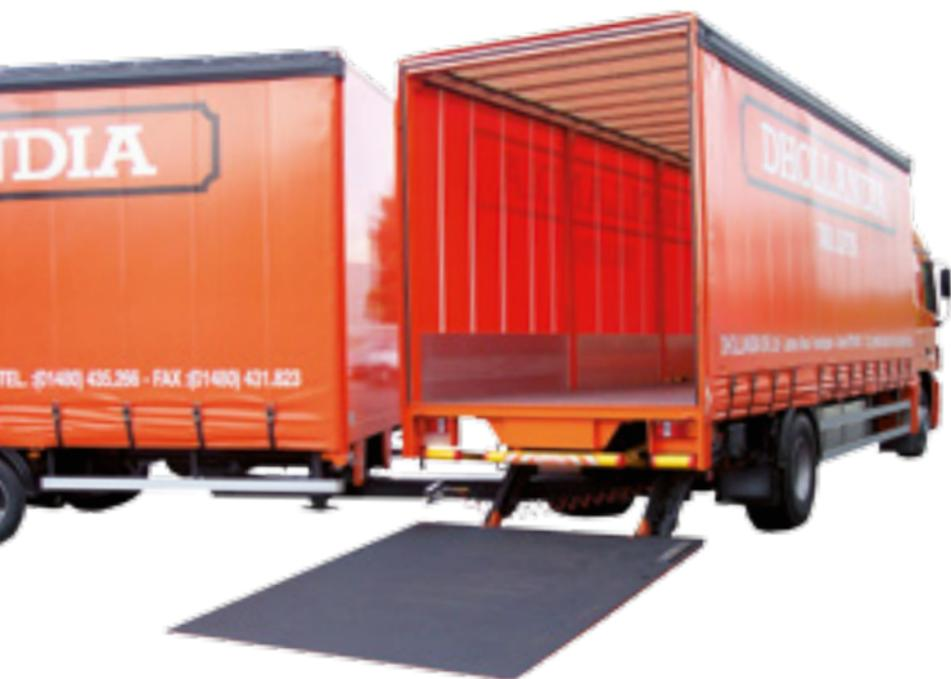
La **DH-LV** è progettata per **autocarri con barra di trazione** montato sotto al telaio del veicolo per il collegamento di **rimorchi con assale centrale**.
